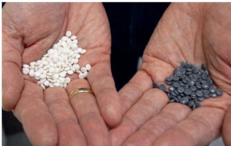
Polyethylen- und Polypropylenrezyklat aus mechanischem Recycling. Früher war das Granulat nur grau erhältlich, nun gibt es dies auch hell. Fotos: Brigitte Osterath
