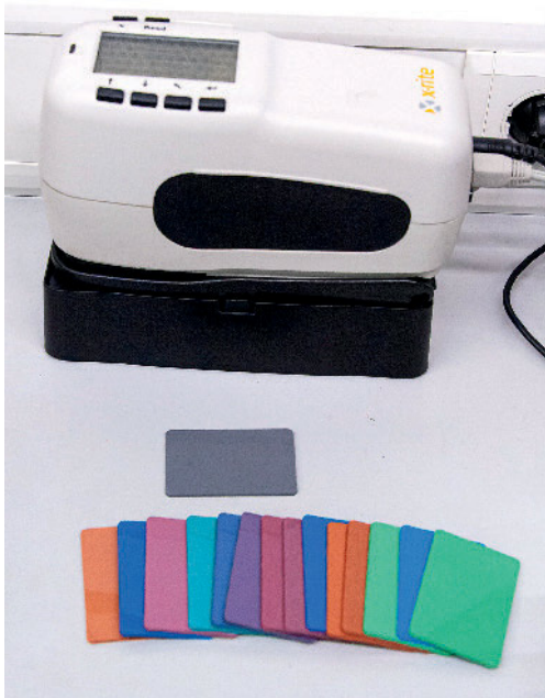
Helles Kunststoffrecyclat lässt sich einfärben – in welchem Farbton, lässt sich mit einem Farbmessgerät bestimmen.
