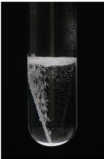
Abbildung 1 Links: Reaktion von Wasserstoffperoxid an einem Platindraht. Rechts: Reaktionsdiagramm zur Erläuterung der Vorgänge der Katalyse.
