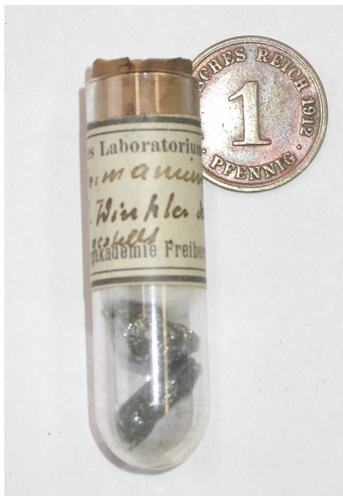
Abb. 12: Bei diesem Gefäß mit der Aufschrift „Germanium von Cl. Winkler hergestellt“ dürfte es sich um eines der ersten Präparate handeln, die aus elementarem Germanium bestehen.
