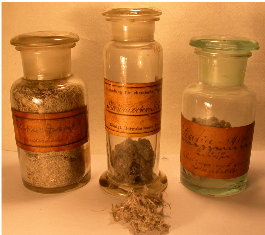
Abb. 8: Platin-Asbest-Kontaktsubstanzen, die Winkler 1875 bei der Entwicklung des Schwefelsäure- Kontaktverfahrens einsetzte.
