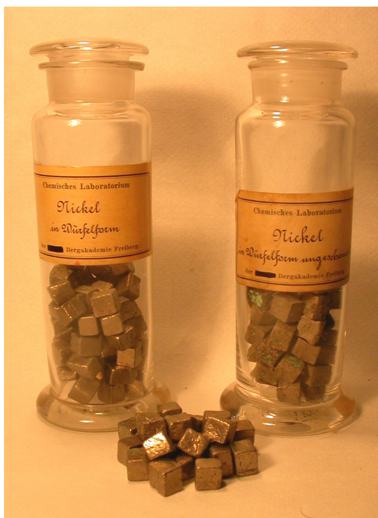
Abb. 4: Das Würfel-Nickel war seit Mitte des 19. Jahrhunderts eines der wichtigsten Erzeugnisse der Sächsischen Blaufarbenwerke.
