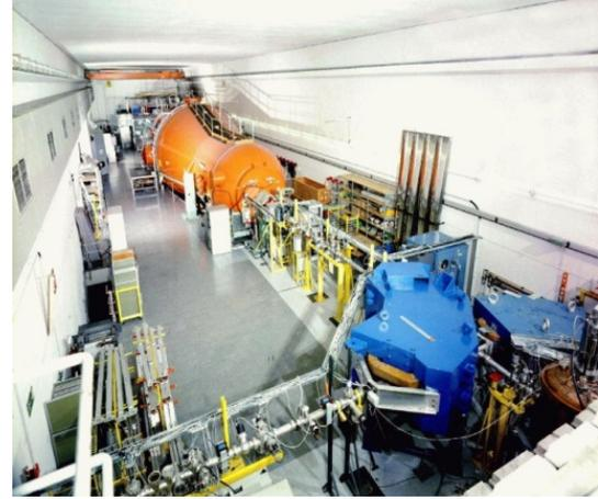
Ein „kleiner“ Anteil der AMS Anlage an dem MLL-TUM: der orange 14 MV Tandem Beschleuniger und der blaue  $90^\circ$  Magnet.
