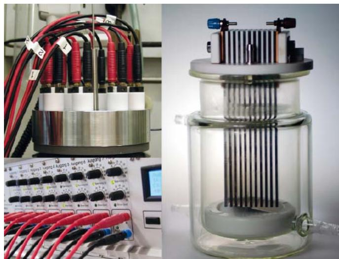
Abb. 5: Elektrosynthetische Screening-Anordnung und bipolare Zelle für multi-molare Umsetzungen
