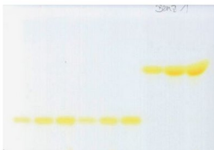
Abb. 3: Trennung von Benzocain (Bahnen 1–6, von links) und 4-Aminobenzoensäure (Bahnen 7–9) auf einer 10 x 10 cm Platte.
