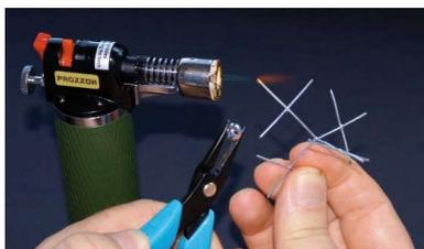
**Abb. 13 Erhitzen des Drahtendes mit einem Flambier-Brenner.**
