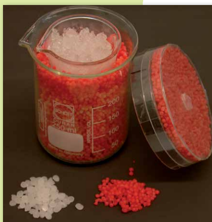
Abb. 14: Paraffinpellets, in Alginat mikroverkapseltes Paraffin und Thermobecher
