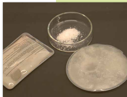
Abb. 3: Latentwärmespeicher in Taschenformat mit Natriumacetat-Trihydrat
