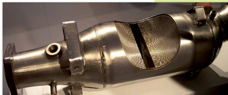
Aufgeschnittener Katalysator für ein Auto (Bild: Stahlkocher, CC-BY-SA 2.0)
