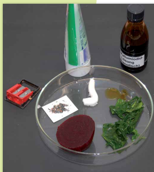
Abb. 7: Materialien für den Bau einer Grätzelzelle
