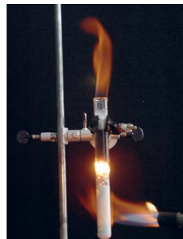
Abb. 3. Ein mit einem Oxi-Reiniger betriebener Hochofen im Reagenzglas: Der Reiniger im Reagenzglas setzt beim Erhitzen Sauerstoff frei. Darüber befindet sich Kohle mit einigen Stückchen Eisenoxid. Der Kohlenstoff verbrennt mit dem Sauerstoff zu \text{CO}_2 (das helle Leuchten in der Mitte), dieser setzt sich dann mit dem verbliebenen Kohlenstoff zu \text{CO} um, welches das Eisenoxid reduziert. (Foto: Marco Rossow)
