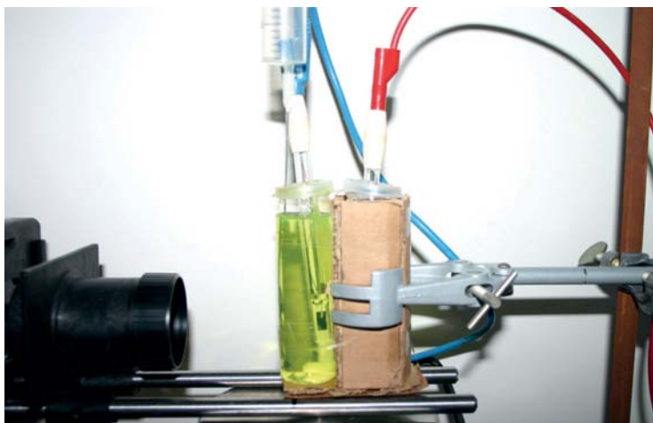
Abb. 1. Solar-Akku als Kompaktzelle zur photoelektrochemischen Lichtenergiekonversion und -speicherung. 2b) (Foto: David Nietz)
