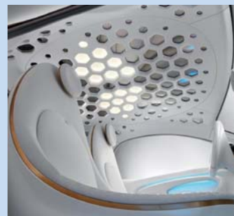
Links: das Dach des Konzeptfahrzeugs mit Solarzellen. Rechts: die einteilige Sitzschale aus langglasfaserverstärktem Polyamid.
