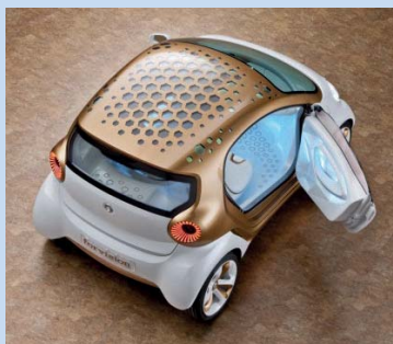
Links: das Dach des Konzeptfahrzeugs mit Solarzellen. Rechts: die einteilige Sitzschale aus langglasfaserverstärktem Polyamid.
