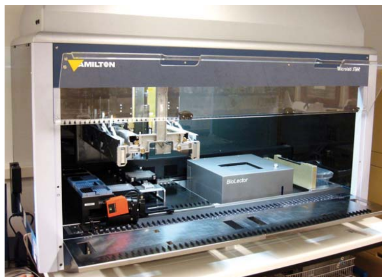
Abb. 7. Beispiel eines teilweise automatisierten parallelen Mikrokultivierungssystems im Mikrotiterplattenmaßstab. Die Anbindung an das Laborrobotersystem erhöht die Automatisierungseffizienz. 69)
