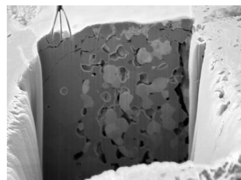
Abb. 4. Oben: Abbildung einer komplexen Anoden-Mikrostruktur mit Ionenstrahlabfräsung und REM-Erfassung in schematischer Darstellung. Unten: Die REM-Aufnahme eines Ionenstrahlgrabens zeigt links den Elektrolyten und rechts die poröse Anode. 14)
