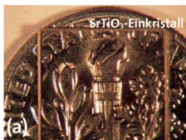
Abb. 9. a) Transparenter \text{SrTiO}_3 -Kristall nach dem Ionenstrahlätzen (Münze als Hintergrund). b) Dichte und Beweglichkeit der elektronischen Ladungsträger in der metallisch leitenden Nanoschicht als Funktion der Temperatur. Die Schicht wurde durch Ätzen mit einer Dosis von 4100 \text{Ar}^+ -Ionen (300 eV) pro \text{Å}^2 hergestellt.
