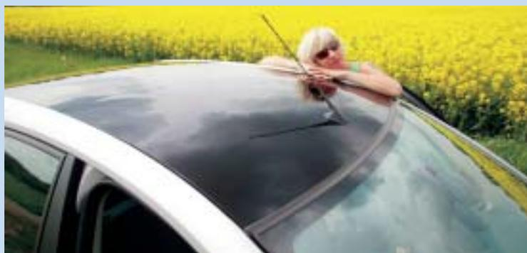
Panoramadach des Smart Forfour: Der vordere Teil besteht aus transparentem Polycarbonat. (Bild: Bayer Materials AG)
