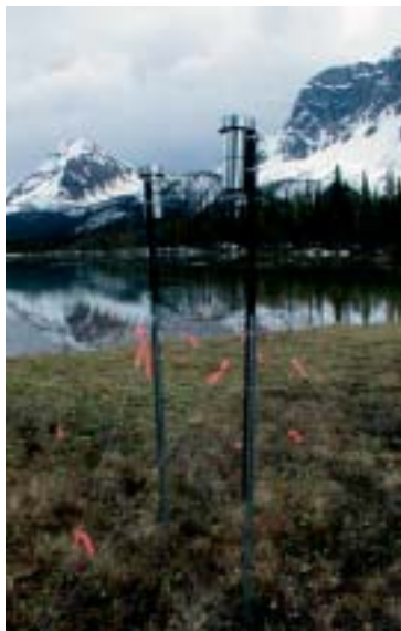
Abb. 3. In den kanadischen Rocky Mountains installiertes Passiv- sammelgerät für gasförmige, organi- sche Spuren- stoffe. 49)
