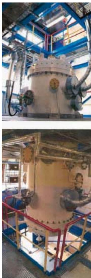
Abb. 2. DEMIS-Pilot-Reaktor. Degussa und Uhde haben diese Mikroreaktor-Pilotanlage, in der PO aus Propen und H<sub>2</sub>O<sub>2</sub>-Dampf hergestellt wird, in Betrieb genommen. Mikrostrukturierte Apparate sichern die stabile Verdampfung von H<sub>2</sub>O<sub>2</sub> in großen Mengen.<sup>74)</sup>
