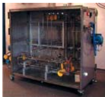
Abb. 2. Kompakter modularer Strömungsrohrreaktor der Bayer Technology Services, Leverkusen.
