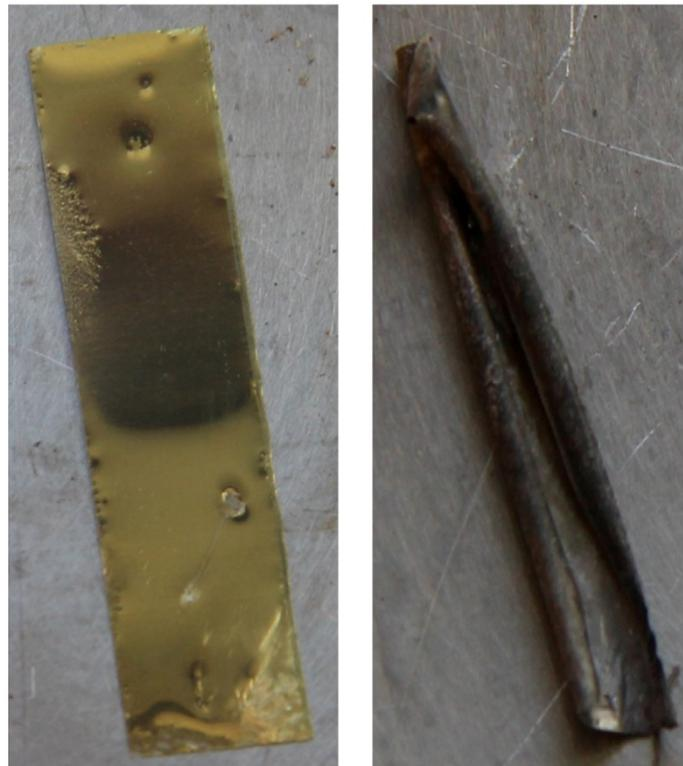
**Abb. 19: Verhalten einer unbehandelten (links) und einer lithiierten (rechts) Zinnfolie bei ca. 250 °C.**
