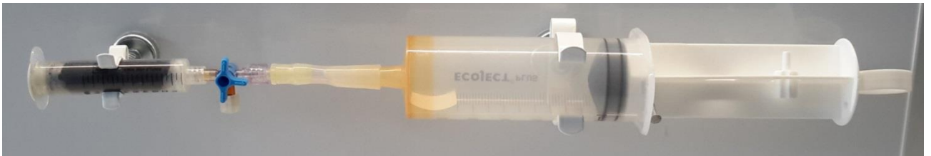
Abb. 9: Vakuumspritze mit Aktivkohlespritze zum Ablassen des gasförmigen Iods.
