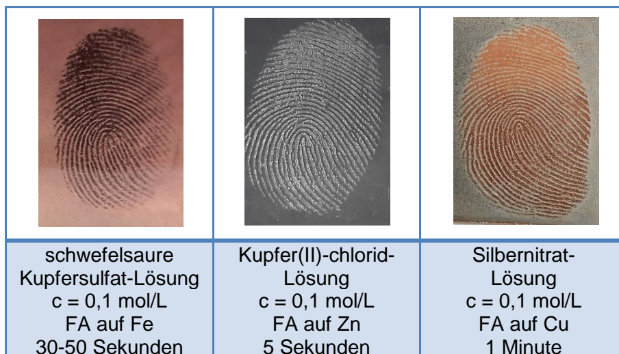
Abb.13: Visualisierte Fingerabdrücke durch Zementation.
