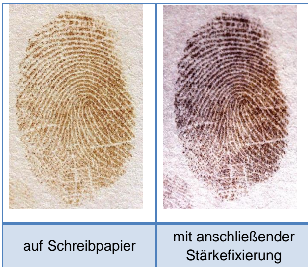
Abb. 10: Ergebnisse durch die Iodmethode visualisiert.
