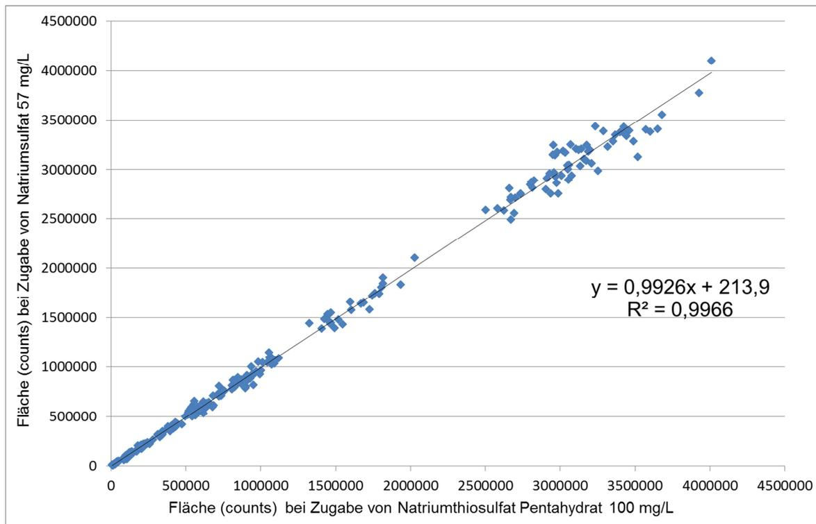
**Bild 7 – Korrelationsdiagramm der Peakflächen bei Zusatz gleicher Ionenstärke von Natriumthiosulfat und Natriumsulfat der untersuchten Substanzen**
