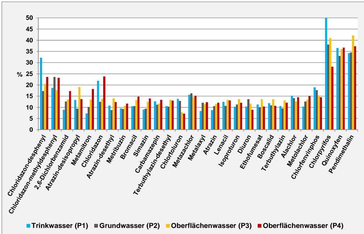
Bild 28 – Übersicht zu den Vergleichskoeffizienten des Ringversuches
