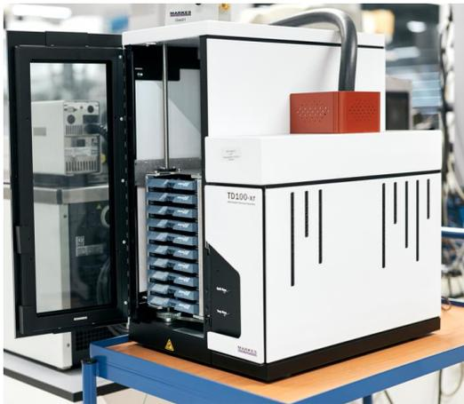
**Abb. 4:** Thermodesorptions-Einheit zur Ausatemluftanalytik
