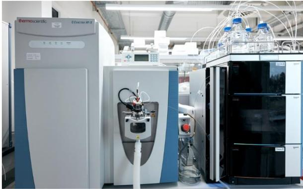
**Abb. 3:** QExactive HFX-hochauflösendes Massenspektrometer
