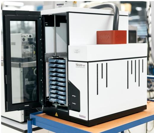
**Abb. 4:** Thermodesorptions-Einheit zur Ausatemluftanalytik
