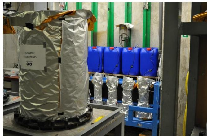
**Abb. 1:** Der Versuchsstand mit Lysimeter (vorne) und gesättigten Säulenversuchen (hinten) bei VEGAS, Universität Stuttgart.
