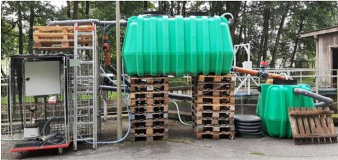
**Abb. 2:** Versuchsanlage zur Nachbehandlung von gereinigtem Abwasser in Kooperation mit utp Umwelttechnik GmbH
