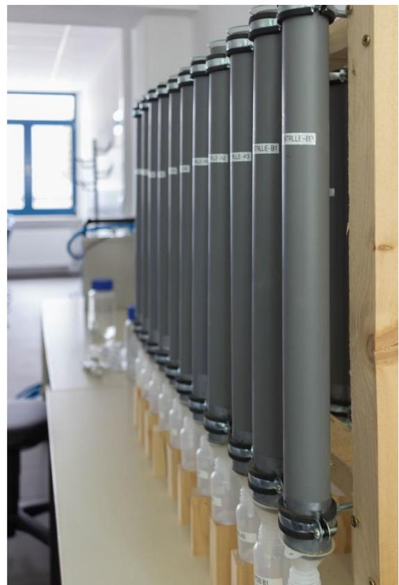
**Abb.1:** Bodensäulenversuch aus dem Projekt PROSPeCT
