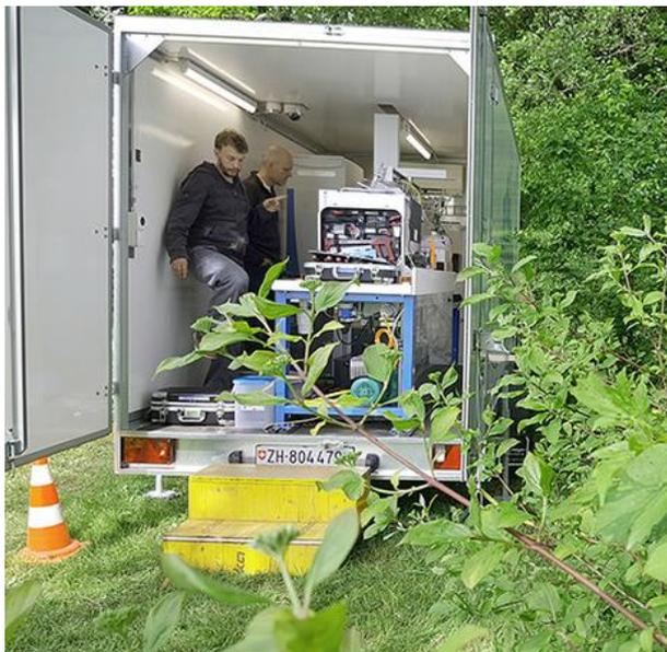
Prototyp des mobilen Massenspektrometers MS2field (Photo: EAWAG)
