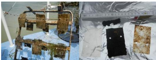
**Abb. 2:** Probenahme mit Silikonstreifen. Oben links: Silikonstreifen vor dem Ausbringen auf einer Halterung aus Edelstahl befestigt; oben Mitte: Schutzkäfig beim Ausbringen von Silikonstreifen im Fluss; oben rechts: Schutzkäfig beim Einholen; unten links: Silikonstreifen mit Biofilm nach Exposition; unten rechts: von links nach rechts: Blindwertprobe, exponierter Silikonstreifen mit dickem Biofilm, exponierter Silikonstreifen nach Vorreinigung
