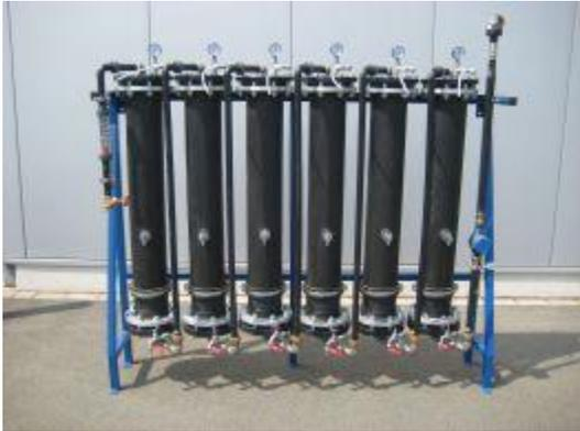
Säulen der Pilotanlage mit Aktivkohlefiltern und Ionenaustauschern (Quelle: LfU)
