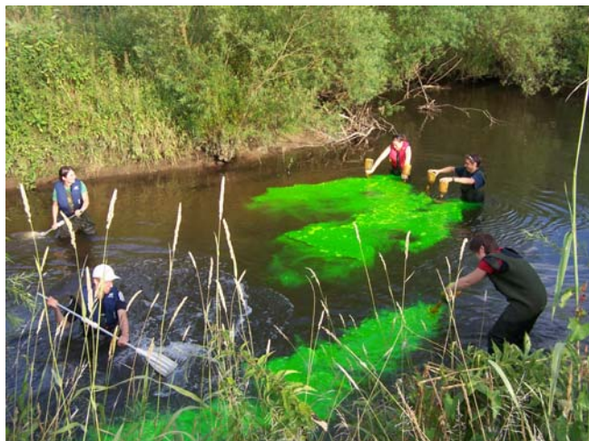
Tracerinjektion zur Bestimmung der hydraulischen Verweilzeit (Foto: Radke)
