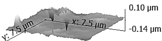
Abbildung 4: AFM-Aufnahmen von PLA in der 3D-Darstellung, (links) Original Polymer, (rechts) Polymer nach 21 Monaten Inkubationszeit im Mesokosmos
