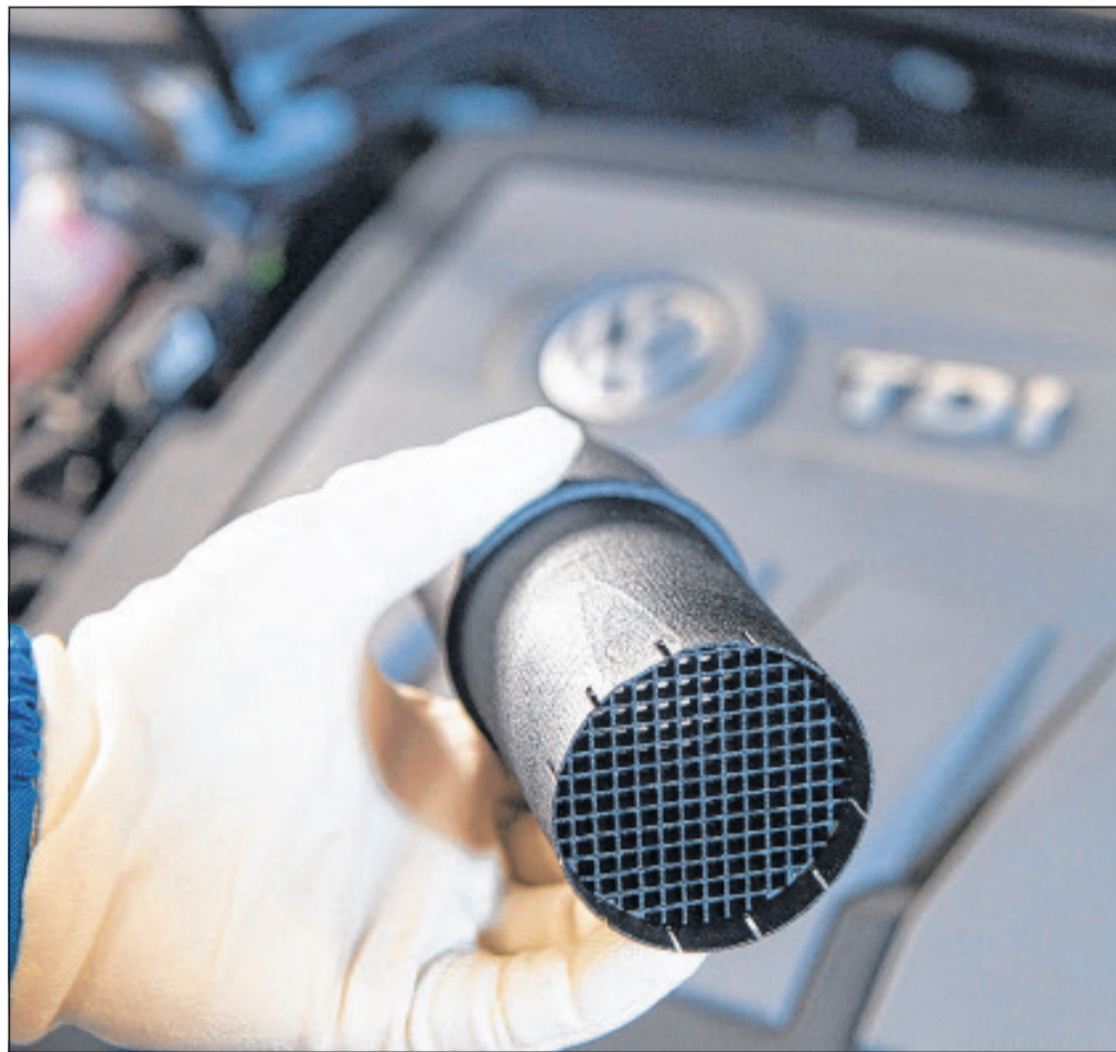
Mit dem Strömungsgleichrichter will VW das Problem hoher Abgaswerte in den Griff bekommen.
