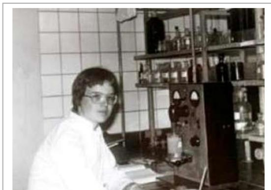
Ich im AC-Grundpraktikum bei der Kupferbestimmung durch elektrochemische Abscheidung
