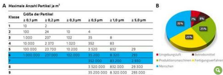
Abb. 2 Klassifizierung der Reinheitsklassen nach DIN EN ISO 14644-1[1] (A) und Kontaminationsquellen[2] (B)
