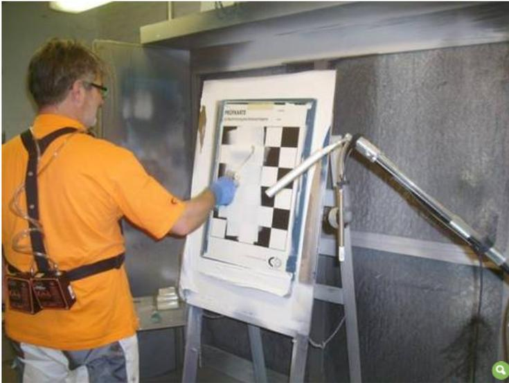
Abb. 3: personenbezogene Expositionsmessung bei Lackierarbeiten unter simulierten Bedingungen
