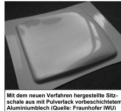
Mit dem neuen Verfahren hergestellte Sitzschale aus mit Pulverlack vorbeschichtetem Aluminiumblech (Quelle: Fraunhofer IWU)
