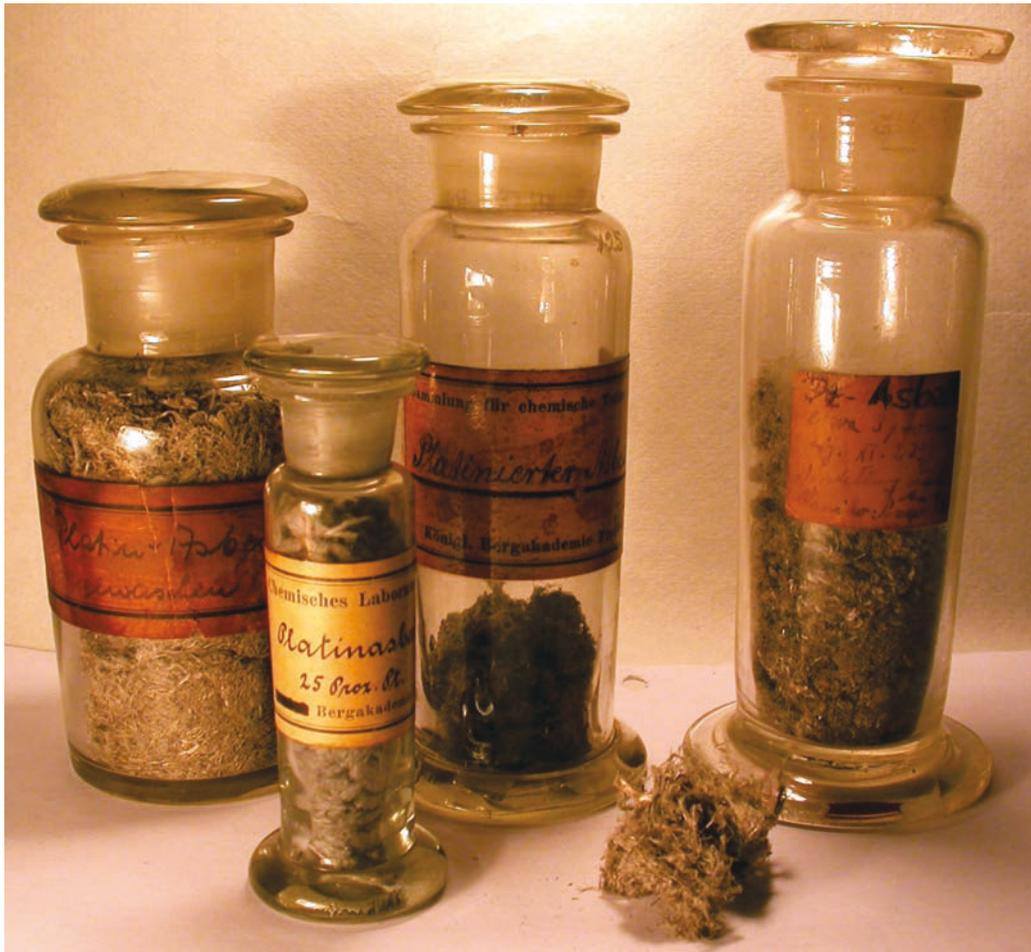
Abb. 4: Einige Proben der von Winkler hergestellten Katalysatorsubstanzen blieben in der Sammlung Chemischer Präparate der TU Bergakademie Freiberg als einmalige Zeugnisse der Chemiegeschichte erhalten. Sein Verfahren zur Herstellung von platinierterm Asbest wurde 1878 patentiert. Alle frühen Kontaktanlagen arbeiteten mit Platinkatalysatoren, erst ab den 1920er Jahren wurde das Edelmetall verstärkt durch das billigere und arsenunempfindlichere Vanadiumpentoxid verdrängt. Foto: Haustein.
