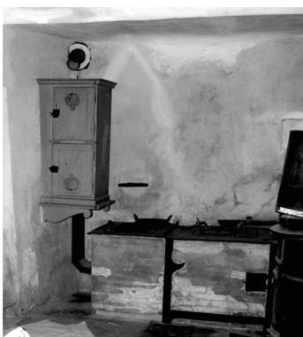
*Abb. 9: Schloss Reichenau. V. r. n. l.: Wasserbad mit der Feuerung seitlich rechts; Sandbad; zwei Trockenschränke, darüber der Eintritt des Abluftrohres in den Kamin. Höhe der Arbeitsflächen 71cm. Foto: Autor.*
