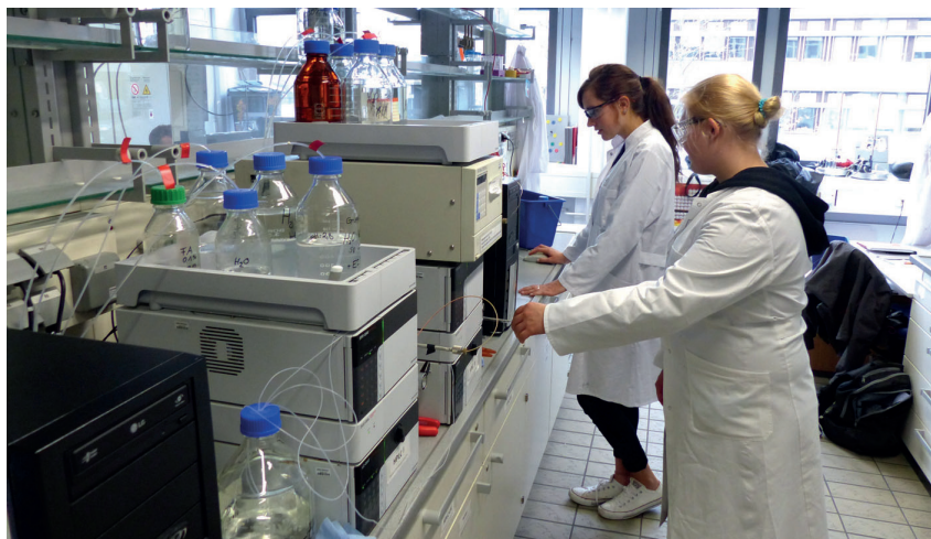
HPLC-Analyse von Bitterstoffen in selbstgebrautem Bier im Rahmen eines Forschungsprojektes der Studierenden im Wahlpflichtmodul Analytische Chemie.
