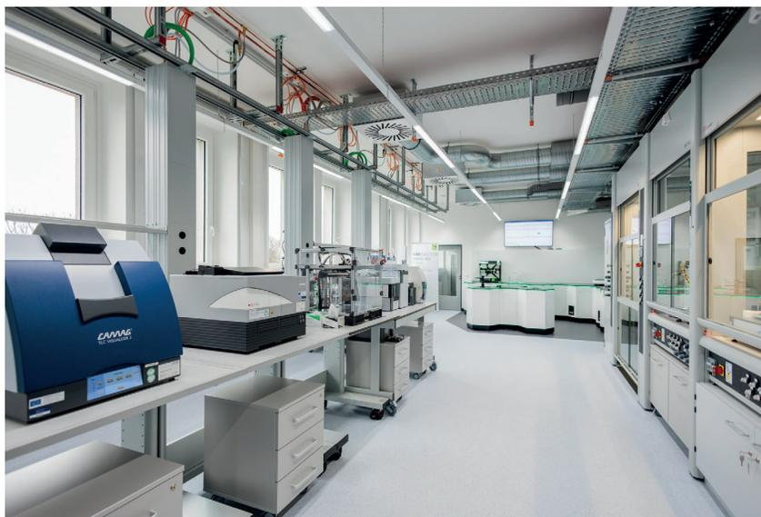
*Blick in das neue FutureLab.NRW am IUTA. Alle Geräte sind auf Rollwagen platziert. Aufgrund der flexiblen Medienführung kann das Labor jederzeit an neue Forschungsfragen angepasst werden.*
