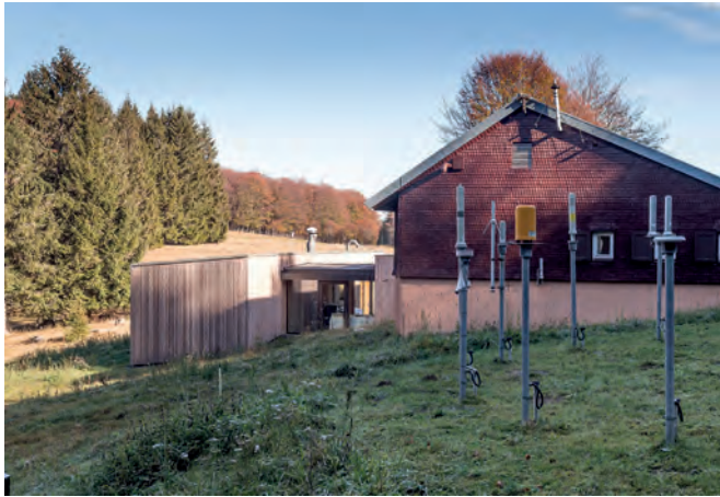
Die Messstation Schauinsland vom Bundesamt für Strahlenschutz misst kontinuierlich die natürlichen und künstlichen Radionuklide in der Atmosphäre. (alle Fotos: C. Horn, BfS)
