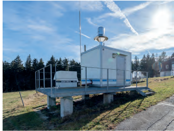
Um auch geringste Spuren an radioaktiven Stoffen nachzuweisen, wird der Luftstaub auf Großflächenfiltern über sieben Tage gesammelt, gemessen und anschließend ausgewertet.
