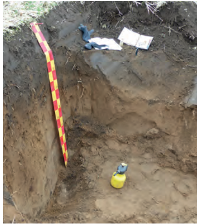
In Zehn-Zentimeter-Schritten wurden in Hügelsheim die Bodenschichten auf PFAS untersucht.
