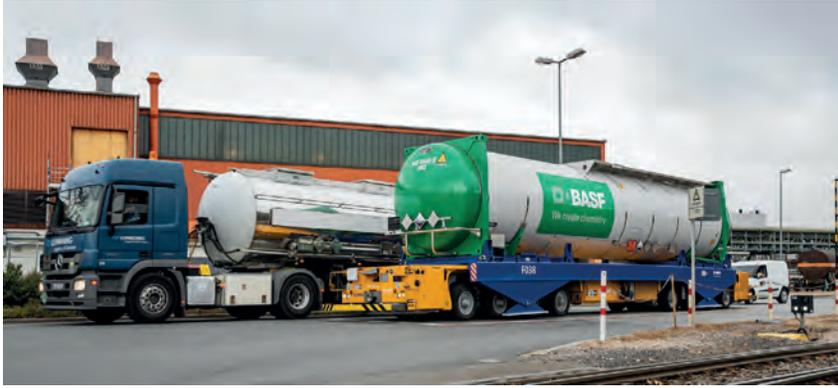
Vollautomatisches Freilager für Tankcontainer am Standort Ludwigshafen zur Lagerung von flüssigen Stoffen und flüssigen Abfällen. Es verfügt über zwei Kräne mit einer Ladekapazität von je 75 Tonnen. Der Warenumschlag kann über automated guided vehicles, Lkw und Bahn erfolgen. (Foto: BASF)
