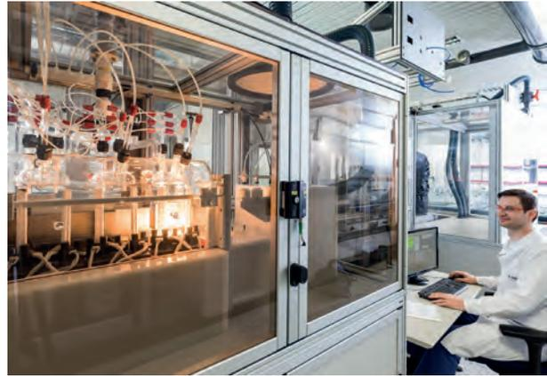
In der BASF entwickelte Roboteranlage „Modular Digestion System (MDR)“ zum vollautomatischen, nasschemischen Aufschluss als Probenvorbereitung für die Atomspektrometrie (Foto: BASF / H.-J. Doelger)
