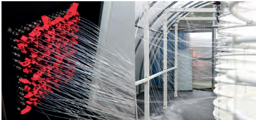
Abb. 2: Spezifischer faseroptischer Schalter (links) und optische Fasern in einem 100 m<sup>2</sup> Photobioreaktor (rechts) zur Prozess-Spektroskopie während der Kultivierung von Algen.
