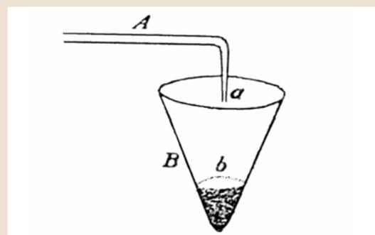
Döbereiners Versuchsanordnung, mit der er die Entzündung von Wasserstoff am Platinkatalysator entdeckt hat.
