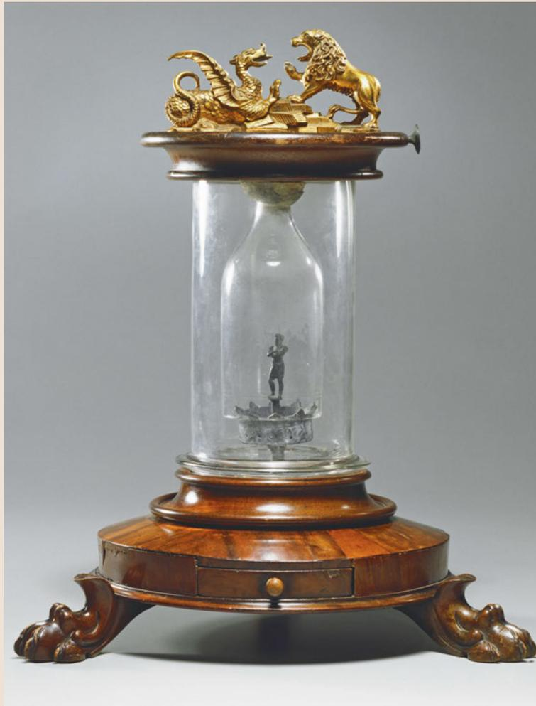
Döbereiner Feuerzeug, nach 1823. Die Austrittsdüse für das entwickelte Wasserstoffgas befindet sich im Maul des Drachens, der es gewissermaßen gegen einen Löwen speit, der seinerseits den als Katalysator benötigten Platinschwamm in seinem Maul hat. Die Zink-Stückchen wurden in einer Bleischale aufgelöst, in der die Figur des englischen Admirals Nelson steht. Foto: Deutsches Museum
