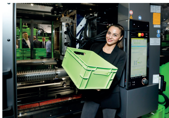
Das österreichische Familienunternehmen Engel verarbeitet mit einer Victory-Spritzgießmaschine Post-Consumer-Abfälle zu Transportboxen. Der Rezyklatanteil beträgt etwa 50 Prozent. Wichtig ist die Sortenreinheit, hier ausschließlich Polypropylen. Das Rezyklat kommt aus Post-Consumer-Sammlungen vom Grünen Punkt, dem Dualen System Deutschland (DSD).
