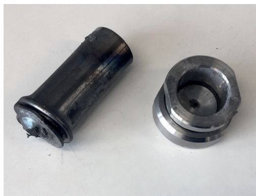
Abb. 2. Ergebnisse von Stahlhülisentests, bei dem ein Stoff in einer verschlossenen Stahlhülse mit Entlastungsöffnung erhitzt wird; oben: negativ, rechts: positiv.
