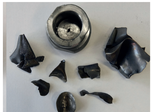
Abb. 2. Ergebnisse von Stahlhülisentests, bei dem ein Stoff in einer verschlossenen Stahlhülse mit Entlastungsöffnung erhitzt wird; oben: negativ, rechts: positiv.
