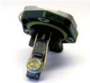
Abb. 4. Käuflicher Ölstandsfühler mit montiertem 10-MHz-QCM-Sensor.
