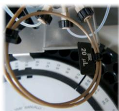
Die Kopplung ist einfach durchzuführen, da nur der Säulenauslass mit einem Zerstäuber verbunden werden muss. Die Eluenten sollten aber auf die Messung mit dem ICP-MS abgestimmt sein: wenig Anteil an organischem Lösungsmittel für stabilen Plasmabetrieb und geringe Salzkonzentrationen um Ablagerungen am Interface zu vermeiden. Die Identifizierung erfolgt mit Hilfe von Vergleichssubstanzen.
