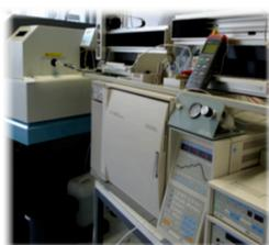
Zur Erhöhung der Flüchtigkeit wird derivatisiert: Methyl-Quecksilber wird ethyliert und im Kapillar-GC als Methyl-Ethyl-Hg vom Diethyl-Hg (aus  $\text{Hg}^{2+}$ ) abgetrennt. Das ICP-MS dient als elementselektiver Detektor. Durch Verwendung von angereichertem Methyl-Hg können auch Isotopen-Verdünnungsanalysen durchgeführt werden.
