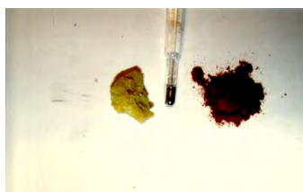
Abb.3: Schwefel, Quecksilber (im Thermometer) und deren Verbindung Zinnober (das ist rotes Quecksilbersulfid).
