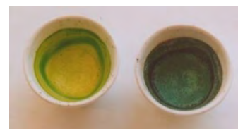
Abb. 3: Oxidationsschmelzen mit Chrom(III)- und Mangan(IV)-oxid: Das Nitrat-Ion oxidiert die nicht säurelöslichen Oxide Cr_2O_3 (grün) und MnO_2 (schwarzbraun) zu löslichem, gelbem Chromat CrO_4^{2-} und blaugrünem Manganat MnO_4^{2-} (ein „Aufschluss“ unlöslicher Proben)
