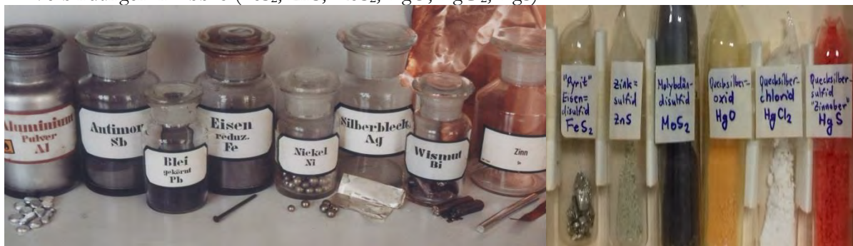
Abb. 4: Schwermetalle (links), Abb. 5: Einige Schwermetallsulfide, -oxide und -halogenide (Abb. 1-5: Eig. Fotos)
