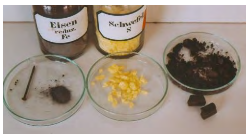
Abb.2: Eisen (links), Schwefel (Mitte) und deren Verbindung Eisen(II)-sulfid
