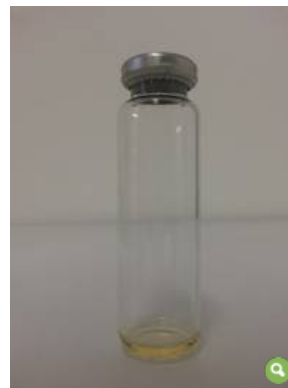
Abb. 1: Headspace-Gefäß mit Serum zur Blutalkoholbestimmung
