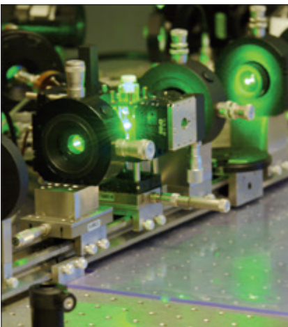
Links: Aufbau zur Aufklärung der chemischen Form gelöster Actinidionen mittels Laserspektroskopie (© KIT, Coerten); rechts: Experimente zur Radionuklidmigration im Grimsel Felslabor, Schweiz (© COMET, Photoshopping, GmbH, Weisslingen)
