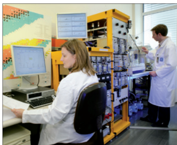
Reaktorchemie: Probenahme, radiochemische Probenaufarbeitung und Strahlungsmessung. (© Framatome GmbH)
