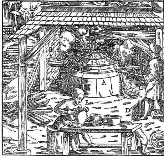
Abb. 2: Der Treibeherd bei AGRICOLA 13 . A: Der Heintze; B: Die scheitter; C: Sylber glette; D: Blaech; E: Der sylberbrenner isset butyr daß ihm das giff / welchs der tiegel von sich gibet nicht schade / dann es ist ein sonderliche artzney widrs giff
