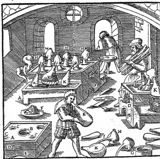
Abb. 5: Herstellung von Scheidewasser ( \text{HNO}_3 ) und Königswasser ( \text{HNO}_3/\text{HCl} ) bei AGRICOLA. 46 A: Der heintze; B: Sein rundtloch; C: Windtlöcher; D: Das auge des heintzen; E: Das spundtloch under ihm; F: Der tiegel; G: Der kolben; H: Der treibhut; I: Sein schnautzen; K: Das vorleg-glaß; L: Der korb darein dises / daß es nicht zerbreche gesetzt wurd
